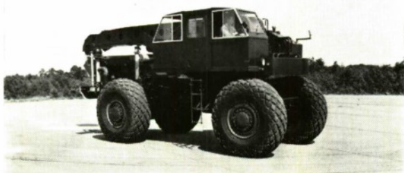
FIG. 10. Rough Terrain Crane.
