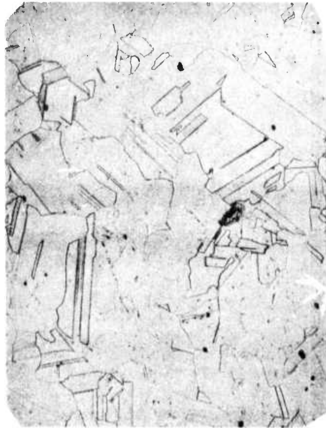
Fig.7-4 310S Stainless steel base metal, sensitized (21XX) (X150) Aqua Regia etch
