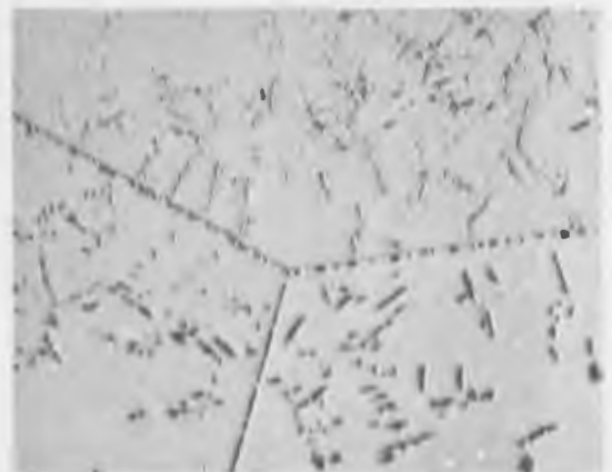
(d) (18,704) Solution Heat Treated+ 1 Hr. at 1500°C
