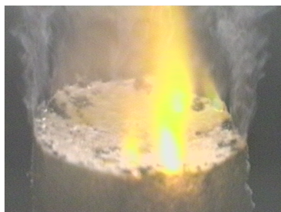
d. HMX2 burning at 3.0 MPa. hmx2\hmx230m.avi hmx2\hmx230m.mov
