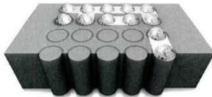
Abbildung 6.1: Das SILEX-Konzept mit gefüllten runden Durchkontaktierungen. Die Verdrahtung und das Aufbringen der Lötkekeln erfolgt am Ende der Prozesskette (Bild aus Quelle [70]).
