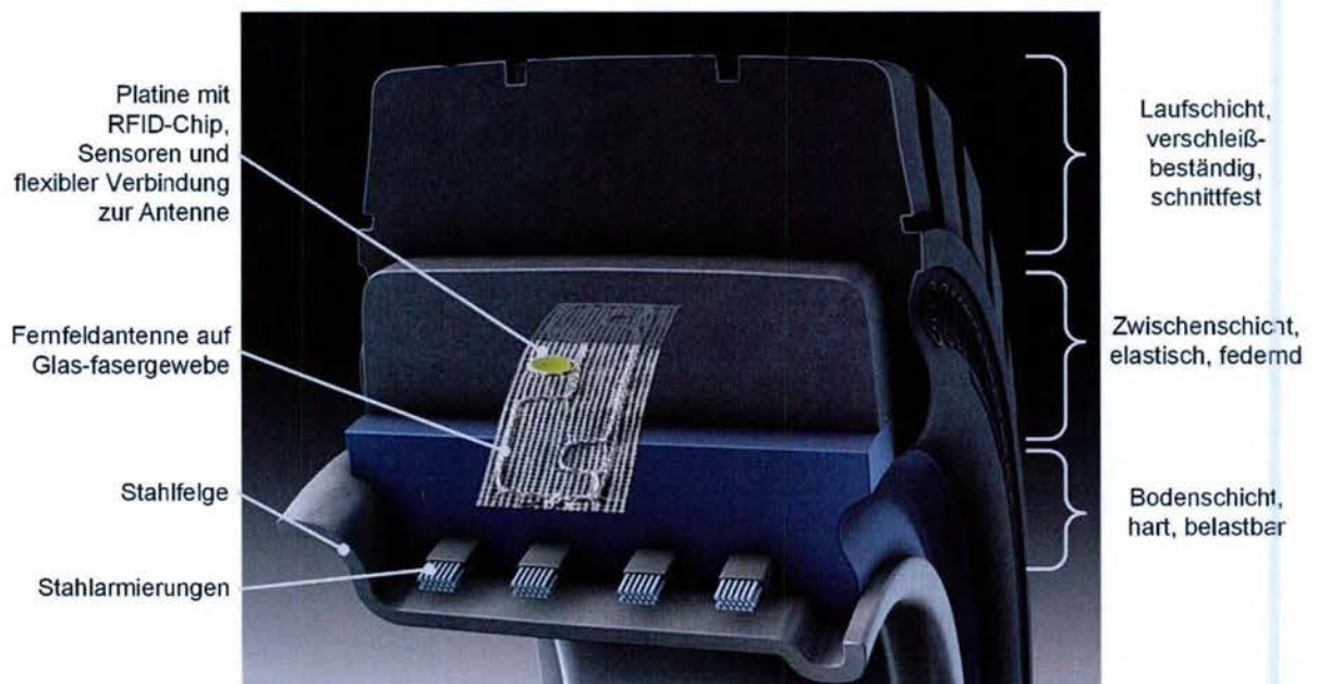
Aufbauschema des SE-Reifens mit integriertem Sensor-Transponder
