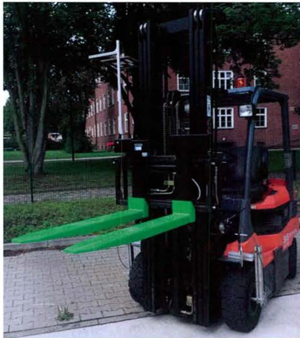
Analyse des Energieverbrauchs: Gabelstapler mit Messvorrichtung
