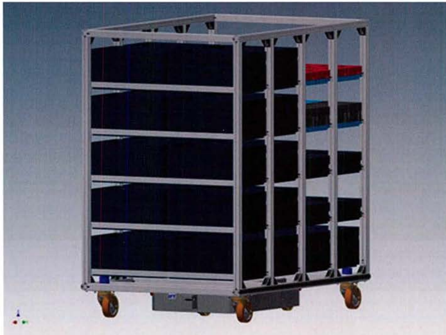
Erster Prototyp: Mobiles KLT-Regal, transportiert von einem Unterfahr-FTF
