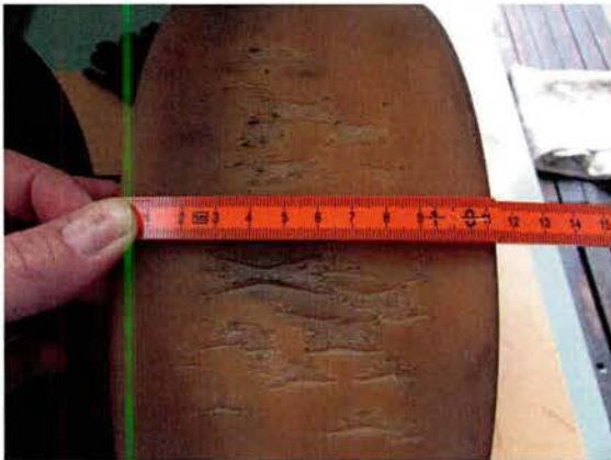
Verschleißerscheinungen an einem Rad
