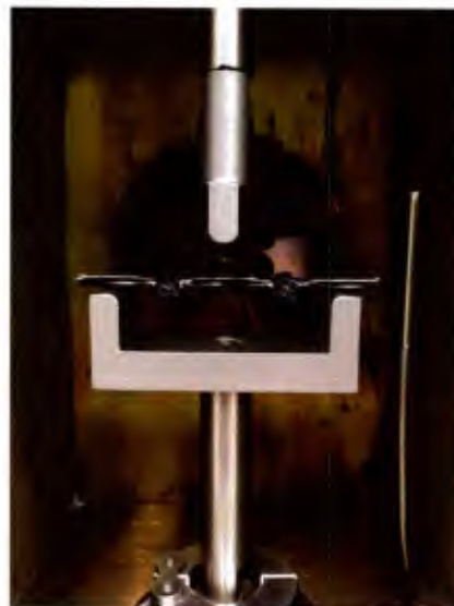
(b) Dreipunktbiegung mit 40 mm Stützweite
