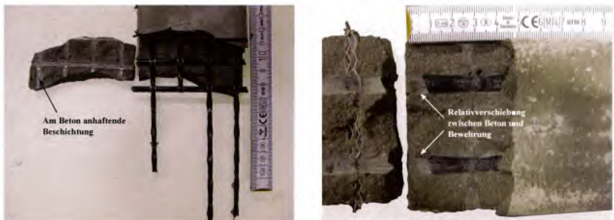
(a) Abgeschnittene Beschichtung, DK-S2-T02-3
