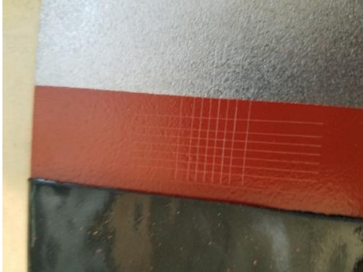
Fig. 13 Cross hatch on XPM primer
