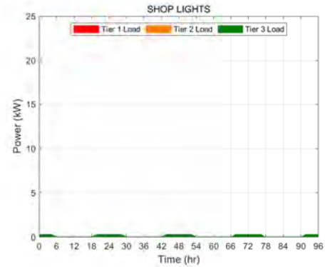
(d) Shop Lights Tiered Electrical Load
