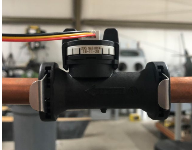
Figure 26. Von Karman Vortex Sensor.
