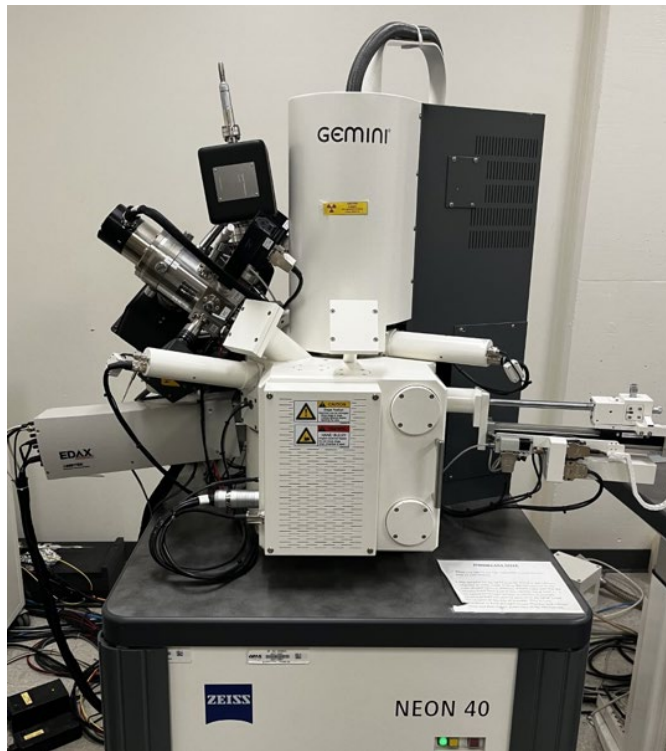
Figure 20. Zeiss Neon 40 SEM
