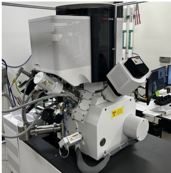
Figure 21. Helios 5 UX SEM
