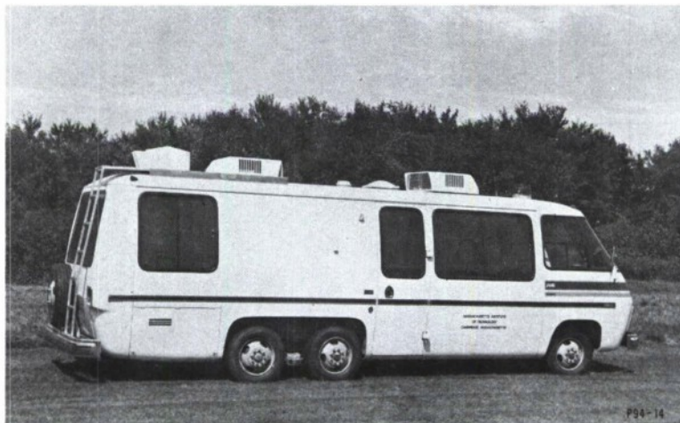
Fig. II-1. Diode laser air-monitoring van.
