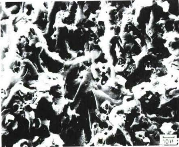
(a) 2024-T3 ALLOY \Delta K = 12.6 \text{ KSI } \sqrt{\text{IN.}}
