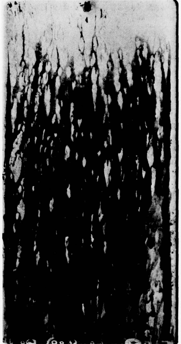
EPOXY PRIMER MIL-P-23377 TOPCOAT MIL-C-81773 GRAY OVERCOAT NRL CLEAR
