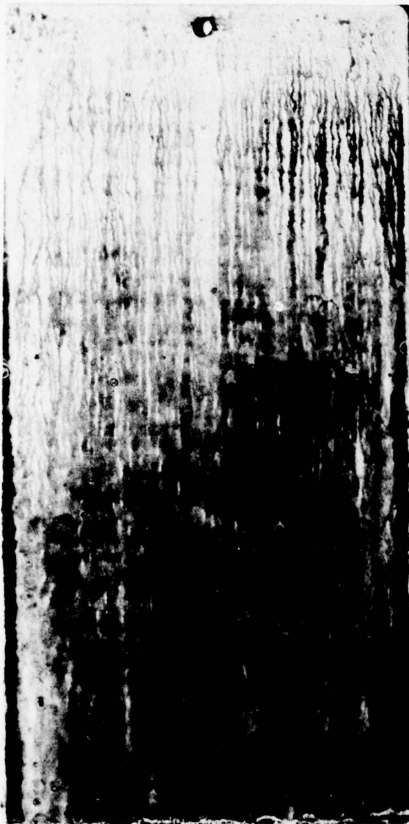
EPOXY PRIMER MIL-P-23377 TOPCOAT TEFLON WHITE
