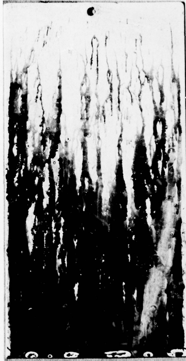
EPOXY PRIMER MIL-P-23377 TOPCOAT MIL-C-22750 WHITE OVERCOAT NRL CLEAR
