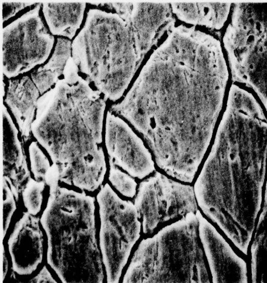
k. HNO_3 ANODIZE (PROCEDURE 10h) 1\mu □ , 2000x
