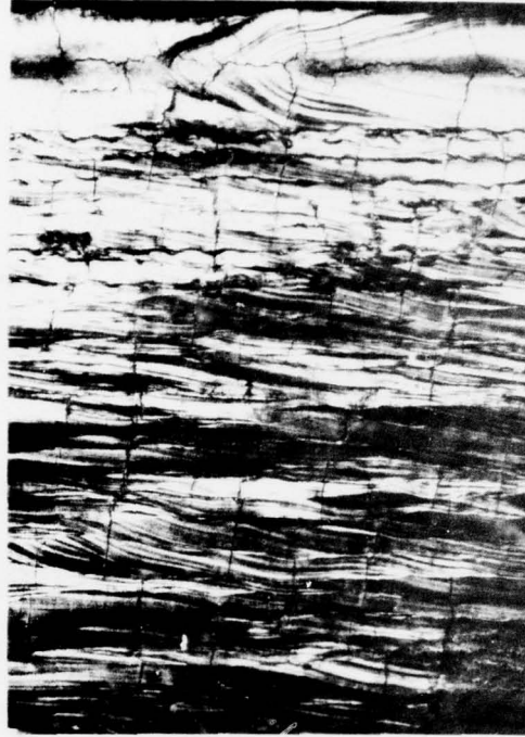
(D) RENE 125, LONGITUDINAL AND TRANSVERSE SURFACE CRACKS
