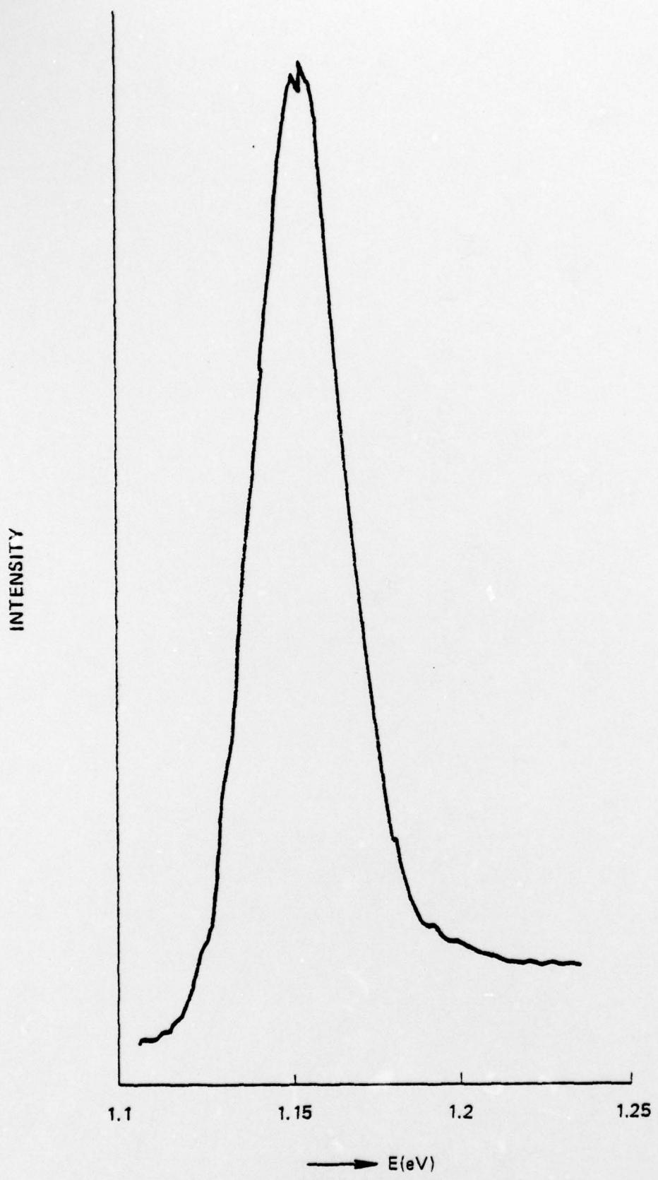
Fig. 5 25% InGaAs photoluminescence spectra.
