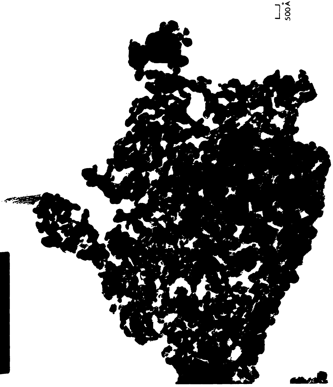
Figure 3: TEM of 3 m 2 /g RuO x .
