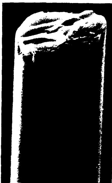
b) BN 257 ( \text{BCl}_3 + \text{NH}_3 , 1050°C, 15 min)
