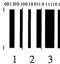
Figuur B.2: Voorbeeld barcode met UPC cijferset.
