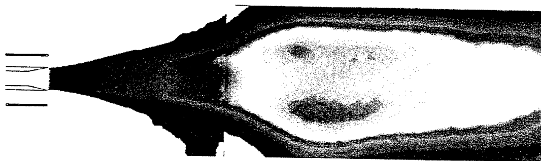
Figure 34: Image d'émission du radical OH^* dans l'UV. 11/03/99, 1 er tir et 25/03/99, 1 er tir. Point de fonctionnement A. Pression 69 bars. Injecteur sans retrait. Ouverture = 4,5. Gain = 150. Filtrage = 1 UG5, 1 WG305, 1 FNQ027, 1 FNQ015, 1 FNQ007. Durée d'exposition = 3760 \mu s. Image non normalisée
