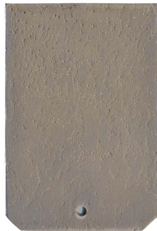
(d) Abrasive Blast + KLEENINHIB 486 + Spray Zinc Phosphate
