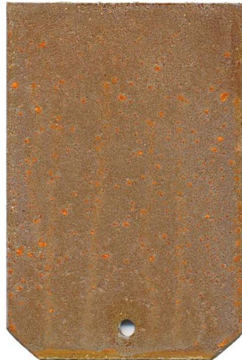
(d) Abrasive Blast + KLEENINHIB 486 + Spray Zinc Phosphate
