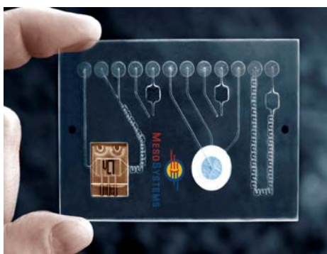
Fig. 2 MICROFLUIDIC disposable cartridge
