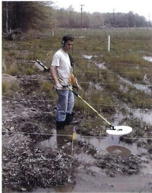
Figure 1. Demonstrator's system, GEM-3 EM Realtime Disc.
