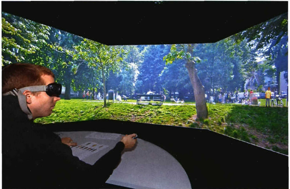
Figuur 6 Foto van de proefopstelling. De foto laat de conditie met een FOR van 135^\circ zien. De proefpersoon heeft een FOV beperkende bril op en heeft de detectieknop en laserdot in de hand.
