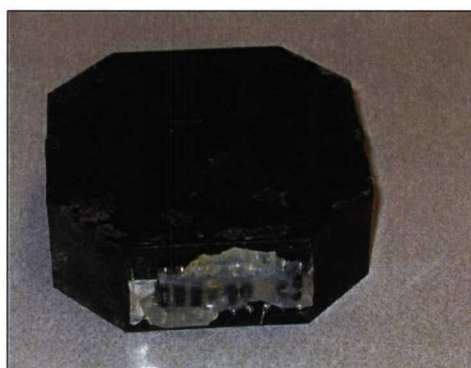
Figuur 52 Foto van de component met de inregelweerstandjes aan de buitenzijde.
