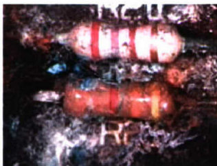
Figuur 21 Weerstanden op een PCB (aangetast door corrosie).
