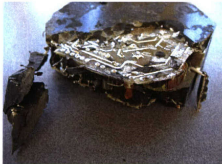
Figuur 56 Dwarsdoorsnede van electronica blok.
