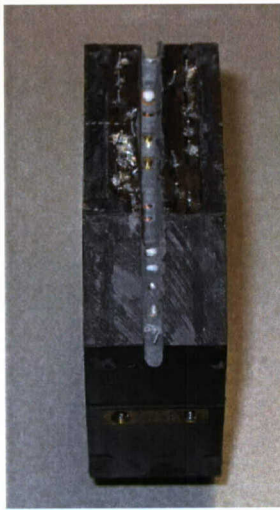
Figuur 54 Zaagsnede in component – men ziet duidelijk de weerstanden tussen de beide ingegoten printplaten.
