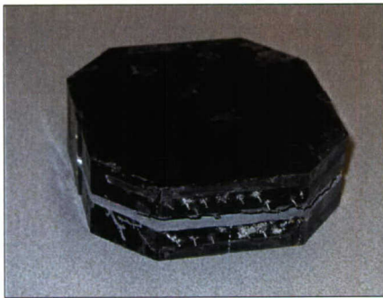
Figuur 55 Op deze foto zijn goed de verbindingspennen zichtbaar die vermoedelijk aan de printplaten zijn gesoldeerd.
