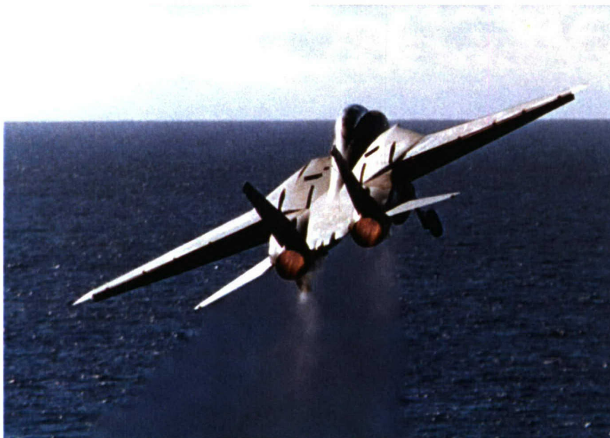
Figuur 1.8 Turbulentie veroorzaakt door de uitlaatpluim van een straaljager.
