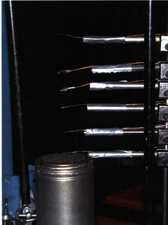
Figuur 3.10 Warmtekanon met daarboven een zestal thermokoppels die de temperatuur in de luchtkolom registreren.
