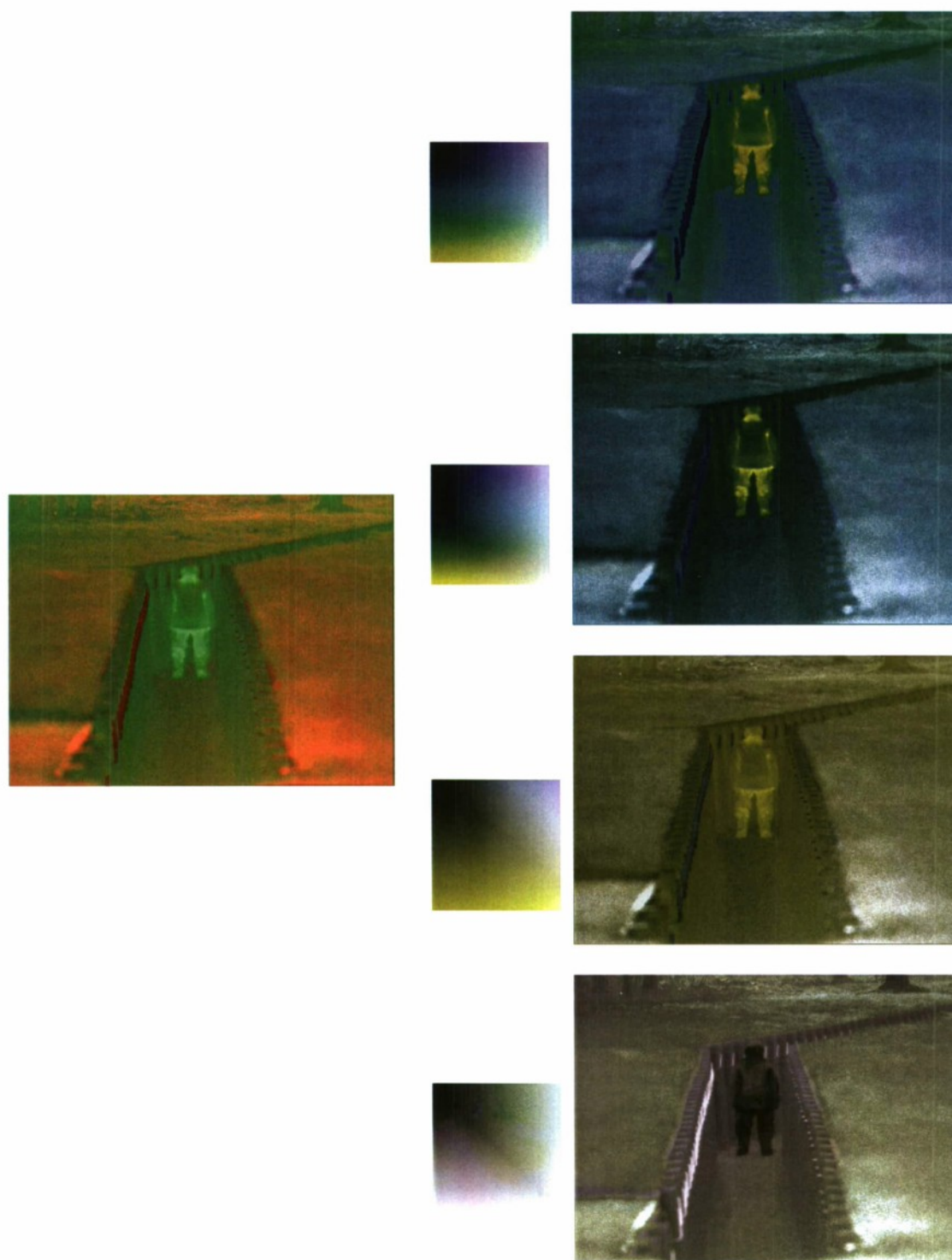
Figuur A.31. Nachtzichtopnamen van de scene uit figuur A.23d: vrouw in loopgraaf. Linker kolom: false colour RG (rood-groen) representatie van de beelden uit respectievelijk figuur A.25i en j. Middelste kolom: de kleurentabellen waarmee het false colour RG beeld wordt omgezet in het corresponderende kleurenbeeld in de rechterkolom.
