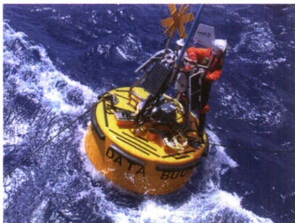
Figuur 4 Verankerde boei met sensoren bij ESTOC (European Station for Time series in the ocean) oceaanstation in de Noordoostelijke Atlantische Oceaan.
