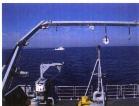
Figuur 3 Een MVP op het dek van de Snellius (links) en een schematische weergave van de werking van een MVP (rechts).
