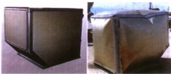
Figuur 4 ECOS3 ™ voor en na een explosietest.
