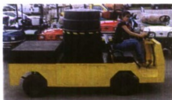
Figuur 8 Explosiebestendige container gebaseerd op blastwrap.
