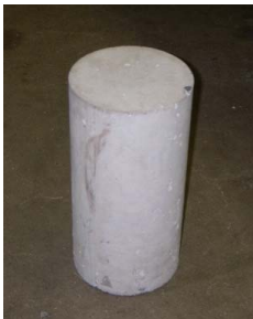
Fig.5 Concrete Cylinder (15(D) x 30.6(H)cm)
