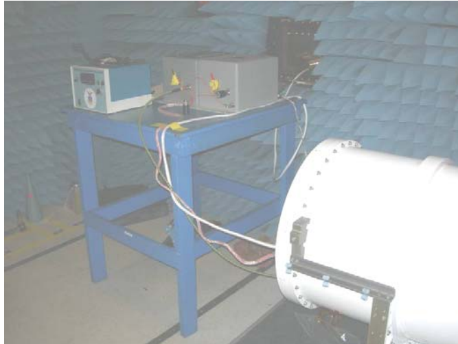
Figure 59. Actual EMI Test Setup at JSC
