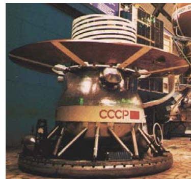
Fig. 1. Venera Flat-Plate Decelerator
