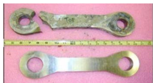
Muzzle Door Linkage Failures
