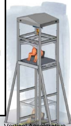
Vertical Accelerative Tower (VAT)
