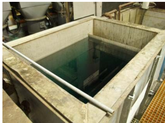
450 Gal vat used for SurTec 580
