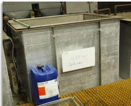
450 Gal vat used for SurTec 580
