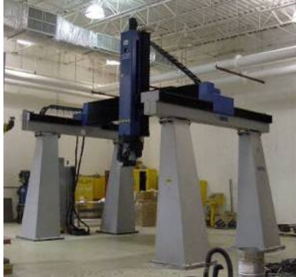
Figure 2. PaR XR125 Gantry robot.
