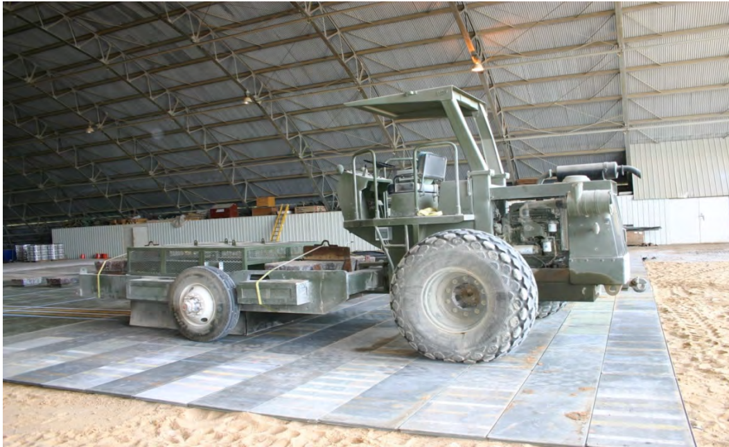
Figure 24. F-15E test load cart.
