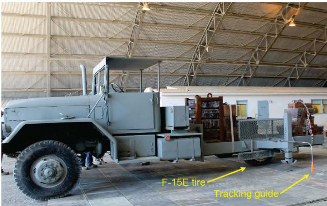
Figure 20. F-15E test load cart.
