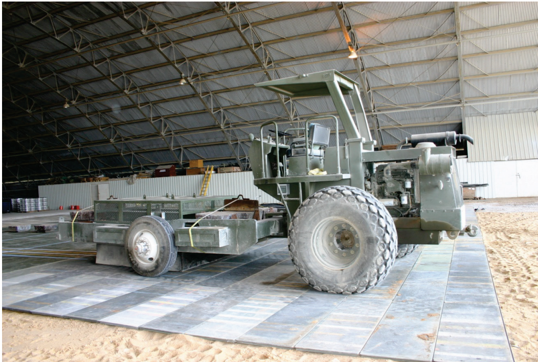
Figure 31. F-15E test load cart.
